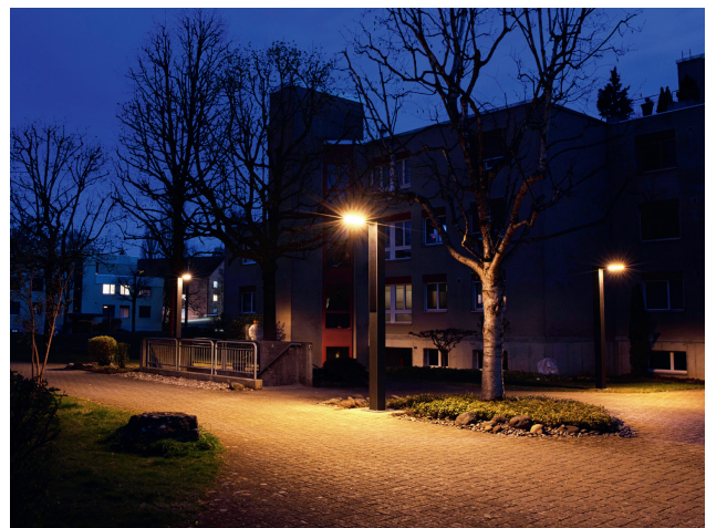
Solarleuchten «merkur» mit wärmerem (2200 Kelvin) und zentriertem LED-Licht sorgen mit Bewegungssensoren für Beleuchtung nach Bedarf.
