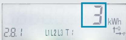
Drücken Sie mehrmals die Abruftaste **B** bis der Tarif 2.8.1 im Zählerstand **C** angezeigt wird.
