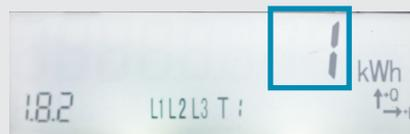
Drücken Sie mehrmals die Abruftaste **B** bis der Tarif 1.8.2 im Zählerstand **C** angezeigt wird.
