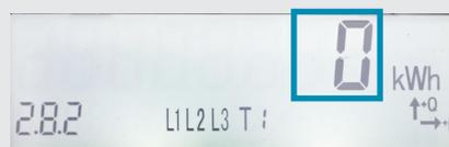
Drücken Sie mehrmals die Abruftaste **B** bis der Tarif 2.8.2 im Zählerstand **C** angezeigt wird.
