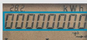
Drücken Sie mehrmals die Abruftaste **B** bis der Tarif 2.8.2 im Zählerstand **C** angezeigt wird.
