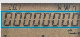
Drücken Sie mehrmals die Abruftaste **B** bis der Tarif 2.8.1 im Zählerstand **C** angezeigt wird.
