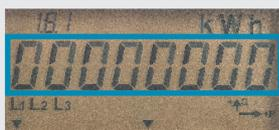
Drücken Sie mehrmals die Abruftaste **B** bis der Tarif 1.8.1 im Zählerstand **C** angezeigt wird.
